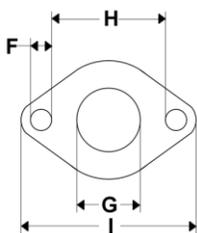
FLANGE FOR HIGH VELOCITY PUMP MODELS
